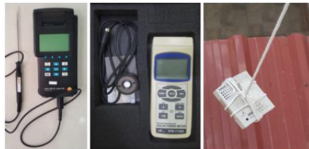
ภาพที่ 2 แสดงอุปกรณ์วัดความเร็วลม (ซ้าย) อุปกรณ์วัดรังสีอาทิตย์ (กลาง) อุปกรณ์วัดค่าความอุณหภูมิและความชื้น (ขวา)
