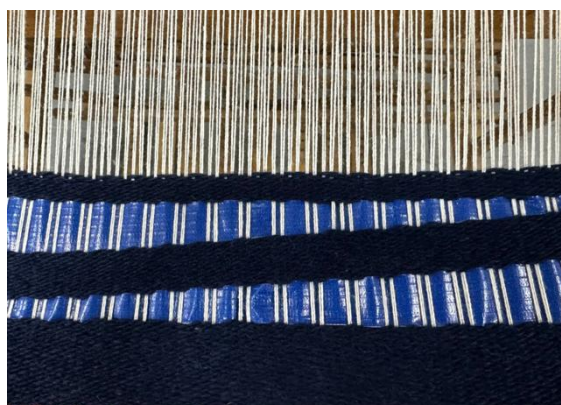
ภาพที่ 9 : ขั้นตอนการทอผ้าด้วยเส้นใย และผสมไวนิลเข้าไปให้เกิดเป็นลวดลาย
