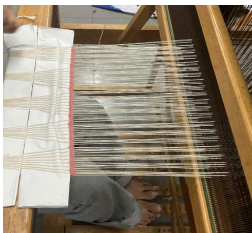
ภาพที่ 7 : การขึ้นเส้นยืนบนกี่ทอผ้า ก่อนที่จะเริ่มการทอ
